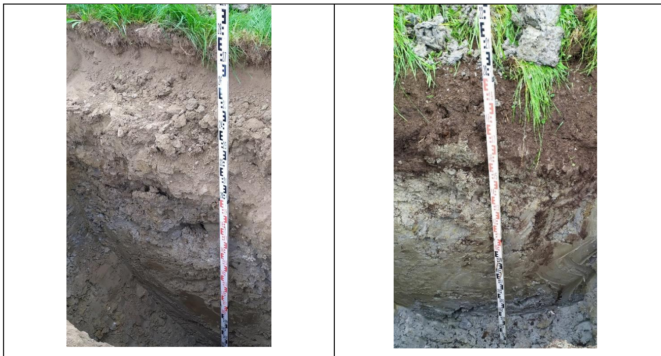
Figure 25 : Sondage à la pelle mécanique, à gauche hors zone humide sondage n°1, à droite dans la zone humide sondage n°2
