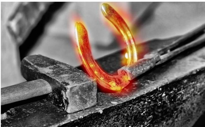
Les outils à la disposition du forgeron étaient des pinces, des marteaux, des masses, des ciseaux, des poinçons, des tranches, des brosses, des griffes et plusieurs autres outils pour travailler le métal. Le forgeron était à même de fabriquer ses propres outils selon ses besoins.
